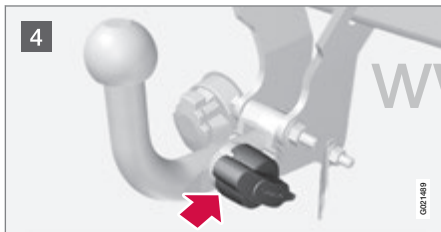
4 插入拖车钩球头部分，直到听到一卡入声。
