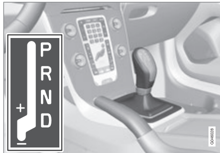
D: 自动换挡位置。+/-: 手动换挡位置。
