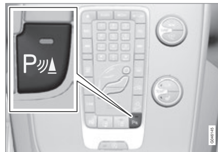
驻车辅助系统和 CTA 传感器打开/关闭。
