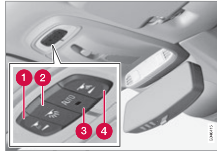
车顶控制台内用于前阅读灯与乘客厢照明的控制器。
