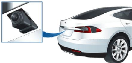
无论何时，当您切换到倒车挡，触摸屏中显示来自摄像头的图像。辅助指示线根据方向盘的位置显示您的行驶路线。当您转动方向盘时，辅助指示线相应调整。
