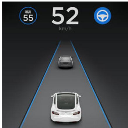
**注：**若要启动辅助转向，在车道线清晰的路面上的行驶速度必须至少为 8 km/h。如果检测到前方有车辆，可以在任何车速，甚至停放状态下，启动辅助转向。
