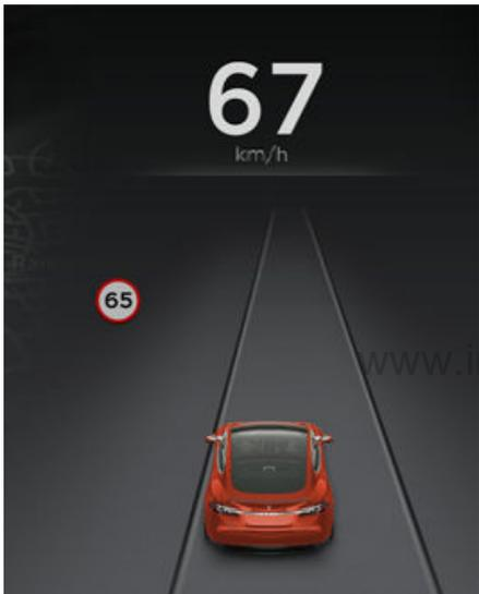
在车速辅助无法检测车速时（例如，当前位置没有限速标志和 GPS 数据），或车速辅助不确定获得的限速是否准确时（例如，尽管最初检测到限速标志，但已经过一段时间未再检测到后续的限速标志），仪表板不会显示限速标志，也不会启动警报功能。
