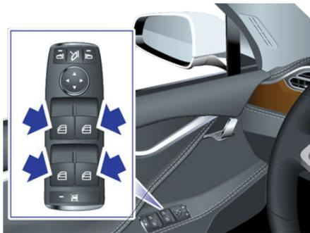
同样，向上推动开关，可升起对应车窗。这项操作也分两级 - 升起车窗时，按住开关；车窗升至所需位置时，松开开关。
