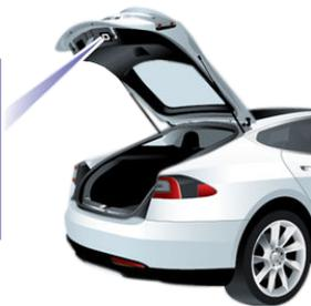
3. 通过关闭行李箱盖，然后重新打开来确认已设置为所需高度。
