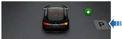
**注：** 只有车辆的位置和/或周围环境允许自动泊车确定适宜的行驶路线时，泊车图标才会出现。如果自动泊车无法确定适宜的路线（例如，在驶入停车位会导致车辆前部进入相邻车道的狭窄街道上），您可以重新停放车辆，寻找其他停车位，或手动泊车。
