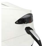
要在公共充电站充电，可将适配器连接到该充电站的充电连接器上。Model S 随车提供有各市场区域最常用的适配器。根据您使用的充电设备，可能需要利用充电设备上的控制装置开始和停止充电。
