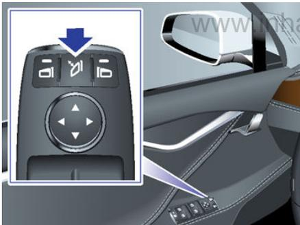
驾驶员侧的后视镜在夜间会根据后车大灯的炫目程度而自动减弱（倒车时除外）。此外，这两个外侧后视镜都配有加热器，与后窗除霜器同时打开和关闭。
