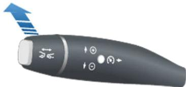
要将巡航控制恢复到先前设置的车速，可直接将巡航控制杆朝着您的身体方向拉动。
