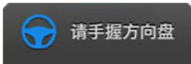
辅助转向会通过感知方向盘转动时遇到的轻微阻力或手动轻微转动方向盘，探测到您的双手（即无需很大力气来重新接管驾驶）。检测到双手时，此消息消失，辅助转向恢复正常工作。
