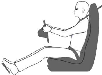
调节座椅位置，以便在尽可能远离前部气囊的同时正确地佩戴座椅安全带：
