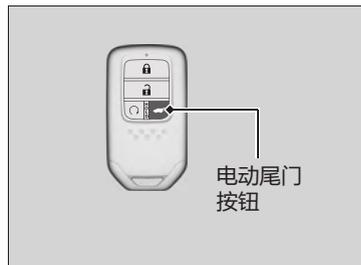
当电源模式处于车辆关闭 (LOCK) 位置时, 按下电动尾门按钮超过 1 秒时, 可进行操作。
