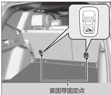
车顶装备有两个用于外侧后排座椅的紧固带固定点。安装有安全带且带有紧固带箍带的儿童座椅可用紧固带箍带增加安全性。
