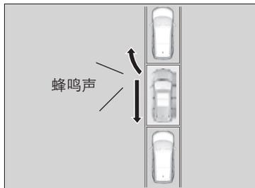
4. 以方向盘在中央位置向后移动车辆，直到出现请停车信息。如果辅助开始前进，则跳过此步骤至第 5 步。
