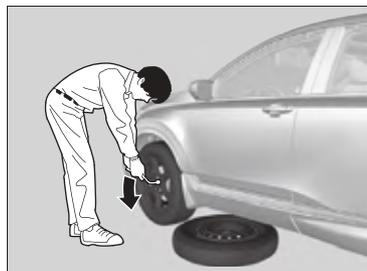
7. 用车轮螺母扳手松开各车轮螺母约一圈。
