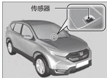
气温控制系统配有传感器，切勿遮盖传感器或将液体溅在传感器上。
