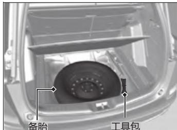
2. 从行李箱内取出工具包，从工具包内取出车轮螺母扳手和千斤顶手柄接杆。
