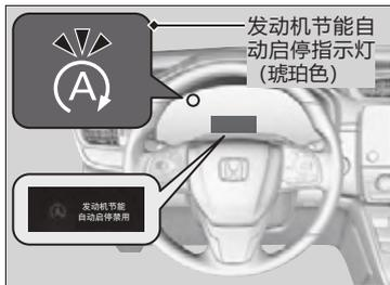
若要关闭发动机节能自动启停系统，按下此按钮，发动机节能自动启停系统将停止。
