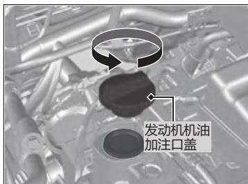
1. 松开并取下发动机机油加注口盖。
