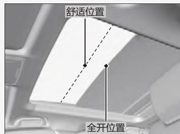
单次操作无法使全景天窗完全打开。全景天窗设置有“舒适”位置或降风噪位置，其将会首先停在此位置上。若要完全打开，在天窗停止在此位置后，再次向后拉动开关。
