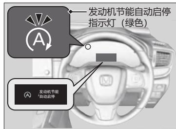
一旦车辆将要再次开始移动或根据环境情况和车辆条件，发动机将会重新启动，且指示灯（绿色）熄灭。
