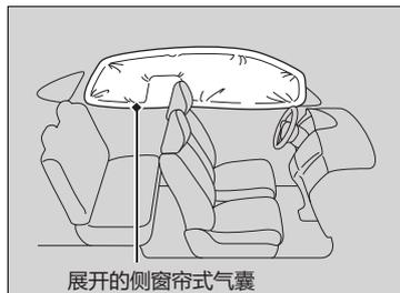
侧窗帘式气囊设计在中度至严重侧面碰撞中展开。
