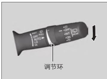
当您控制杆向下推至 **AUTO** 位置，挡风玻璃刮水器刮水 1 次，然后进入自动模式。
