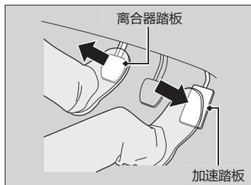
松开离合器踏板的同时踩下加速踏板，释放驻车制动。
