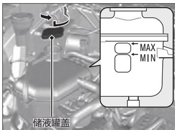
1. 确保发动机和散热器冷却。
