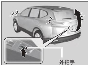
当所有车门都解锁，或按下遥控发射器\*上的尾门解锁按钮时，尾门会解锁。按下尾门外把手并提起尾门。
