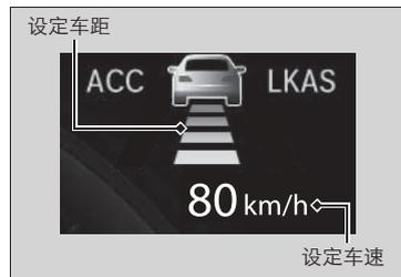
当带 LSF 的 ACC 系统开始工作时，驾驶员信息界面上显示车辆图标、车距条和设定车速。
