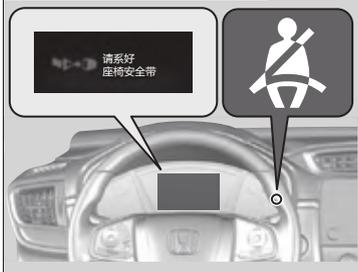
座椅安全带系统包括仪表盘上的指示灯，其用来提醒驾驶员或前排乘客或同时提醒两者都须系紧座椅安全带。如果点火开关转至 ON <sup>\*1</sup> 时座椅安全带未系紧，蜂鸣器将鸣响且指示灯将闪烁。数秒后，蜂鸣声将会停止，指示灯将持续点亮直至系紧座椅安全带。
